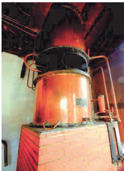
LA CALDAIA DELL'ALAMBICCO
